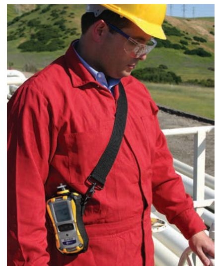
MultiRAE utilizado para controlar la exposición de los trabajadores en una refinería de petróleo
